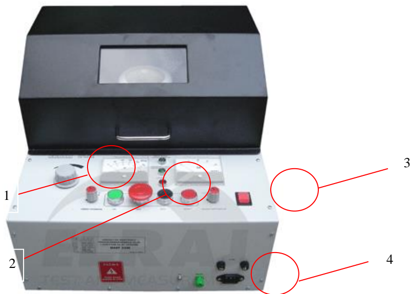
Слика 1. Уређај за испитивање трафо уља и заштитне електроизолационе опреме OEST 35M
