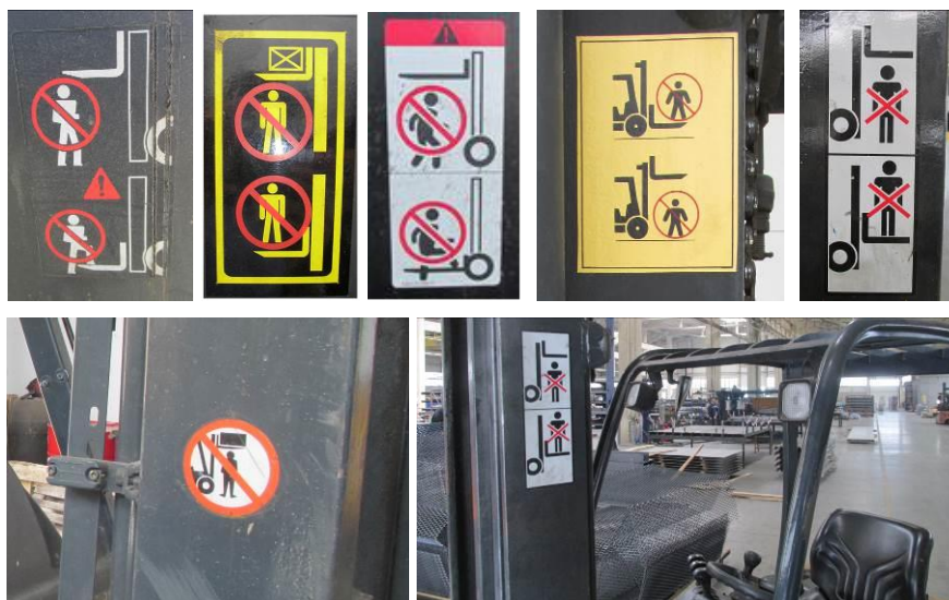
Слика 4. Примери ознака забране - забрањено стајање на/испод виљушки (сопствени извор)
