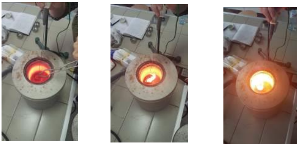
Слика 3 – Одређивање класе опасности дувана у „тигл пећи“
