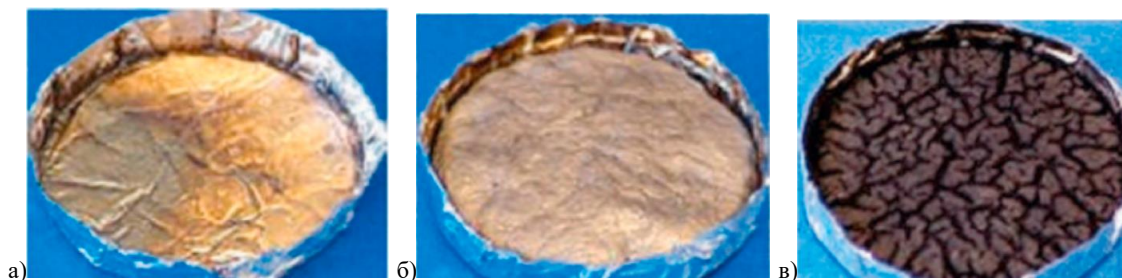
Слика 2. Остатак горења чистог полиметилметакрилата, ПММА (а) и његових композита са 0,5 мас. % једнослојних наноцеви (б) и 0,5 мас. % вишеслојних угљеничних наноцеви (в) [16]
